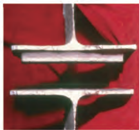
(b) 下翼板裂纹萌生
