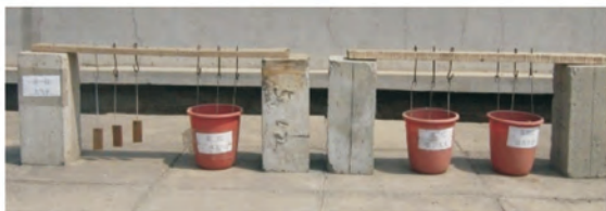
图 1 腐蚀挂片试验装置
