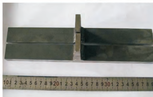
(b) T型焊接头
