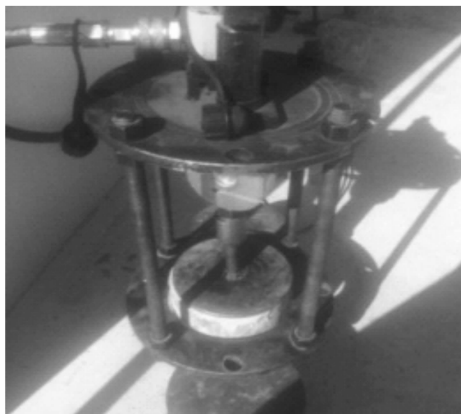
图 3 抗拉强度试验
