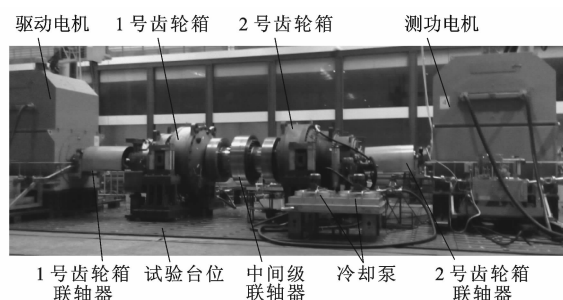
图2 静电监测试验台
