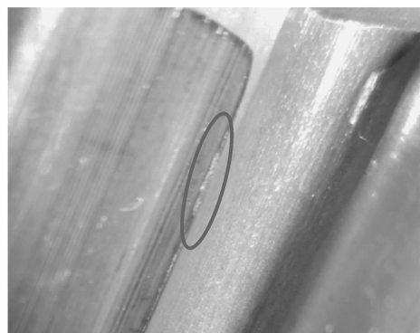
图22 齿根点蚀
