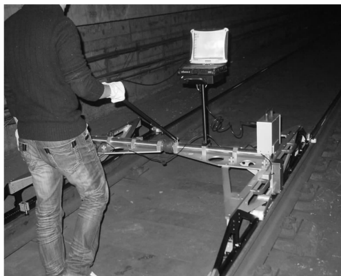
图3 RMF 型波磨测量仪
