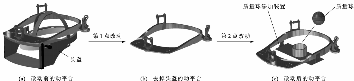
图 16 试验装置的改动方案
