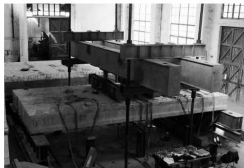
图 9 足尺试验模型
