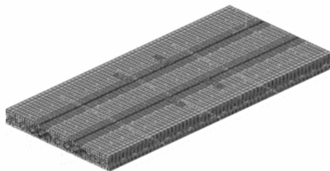
图 14 铰接空心板有限元模型
