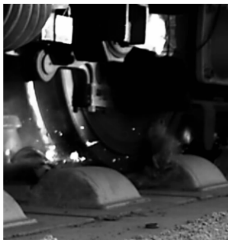
图 10 CRTS II 型轨道的碰撞情况
