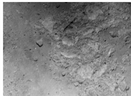
(b) 经50次除冰循环的试件表面
