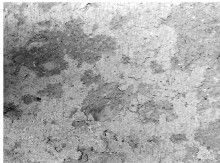
(b) 经50次除冰循环的试件表面
