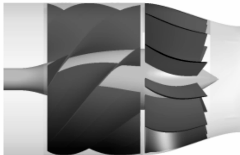
图 15 喷水推进轴流泵几何模型
