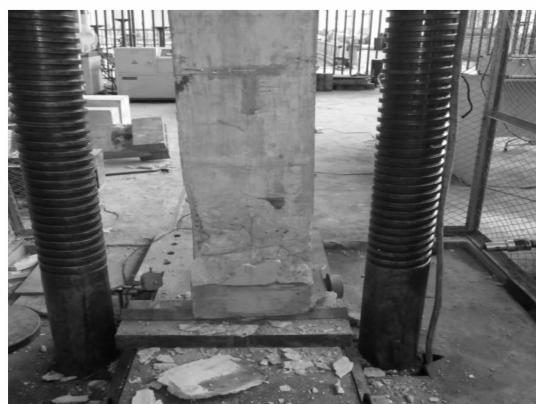
图 5 轴压破坏
