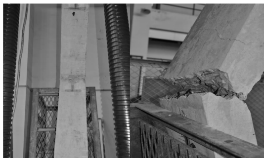
图 7 受拉破坏 Fig. 7 Tensile failure
