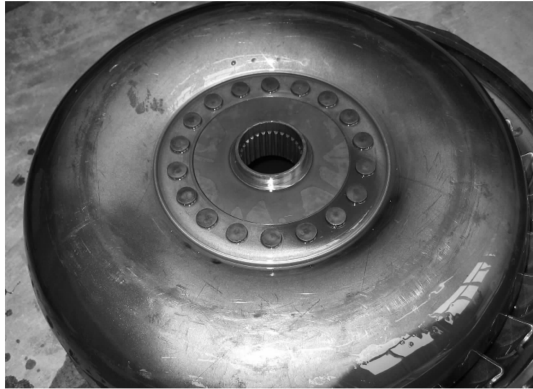
图 6 钣金型液力变矩器
