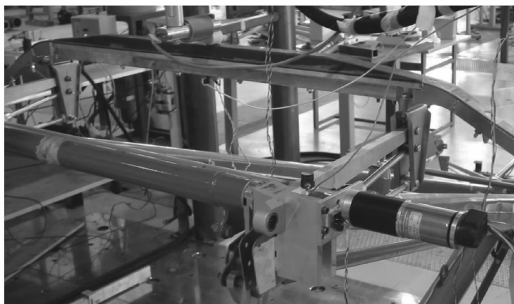
图 6 电磁操动机构
