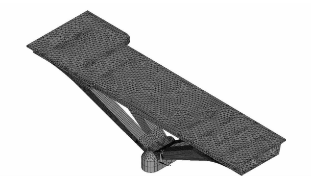
图 4 V 撑局部有限元分析模型 Fig. 4 Local FE analysis model of V-shaped pier
